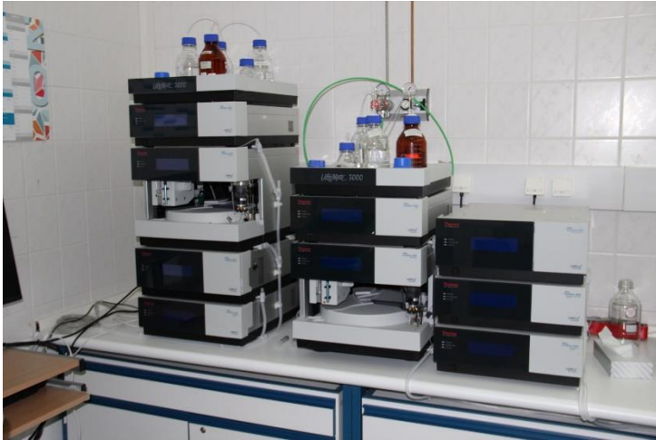
HPLC-Anlage zur Bestimmung von Vitaminen
