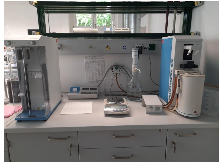
Arbeitsplatz zur Bestimmung der Fallzahl von Getreide
