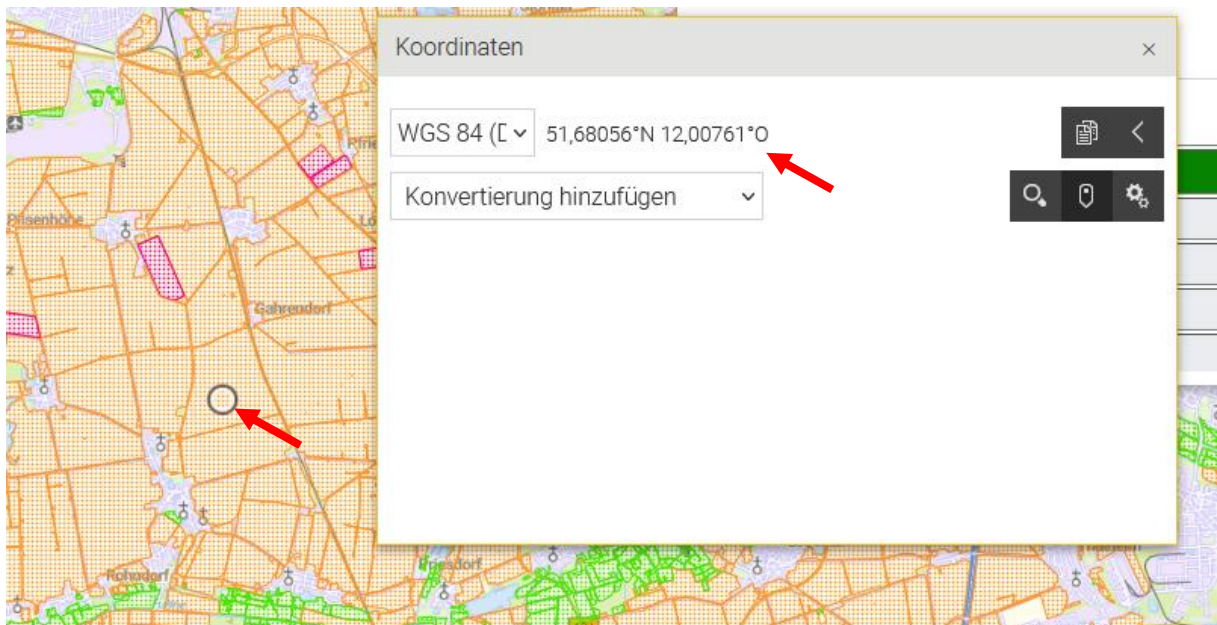
Abb. 7: Nach Setzen einer beliebigen Markierung in der Karte werden der Nord- und der Ostwert als Koordinaten für den Schlag bzw. Feldblock angezeigt. Diese sind anschließend in die DWD-Themenkarte zur Feststellung der nFK für den betroffenen Schlag zu übertragen.
