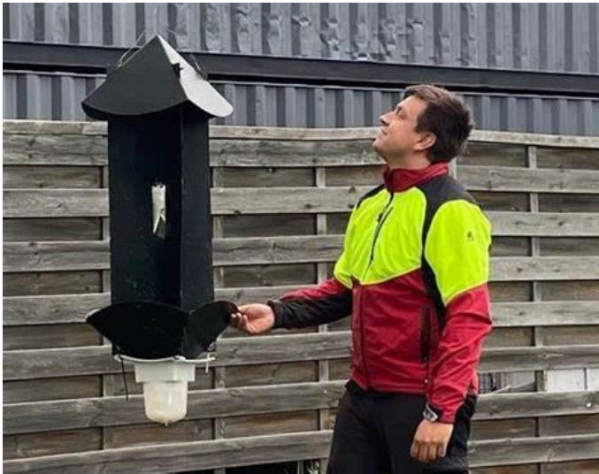
Abbildung 2: Pheromanfalle zur Überwachung des Käferfluges des ALB
