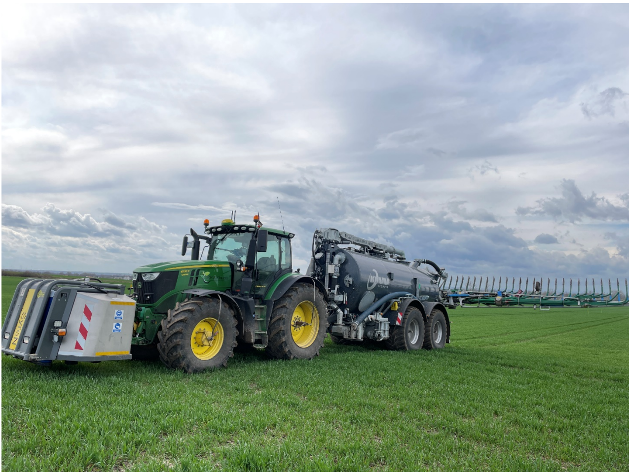
Foto: Ausbringung von Gärresten mit Schlepschuh und Ansäuerungstechnik in den wachsenden Weizenbestand (A. Grabow, LLG)
